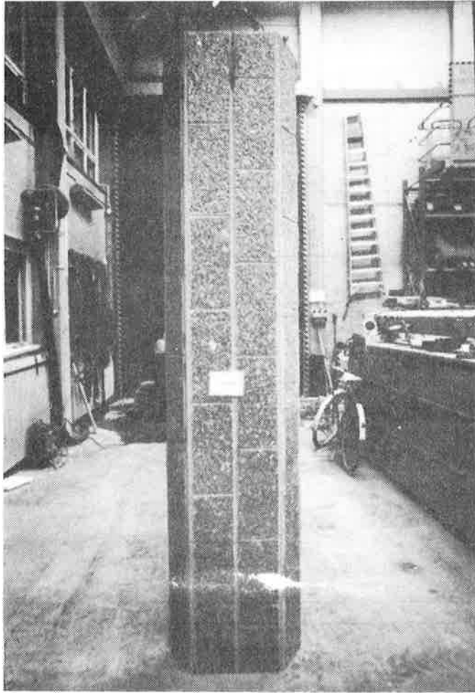
Kuva 63. Kivilaattapintainen ferrobetoninen koe-elementti.
