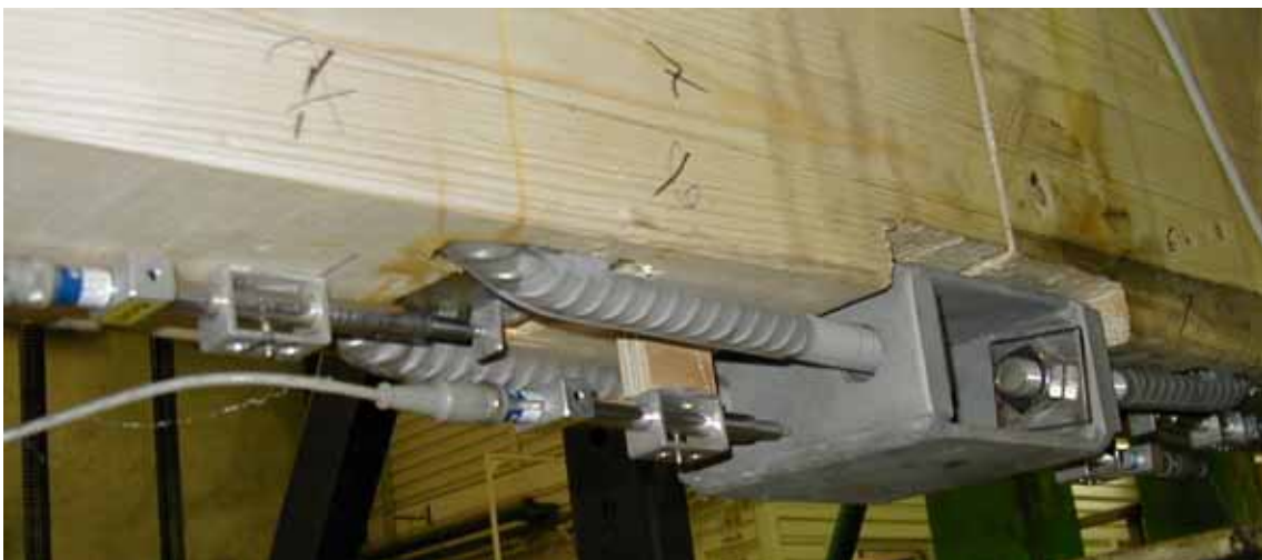
Kuva 4.4. Liitosliukumien mittauksessa käytettyjen anturien sijoitus.
