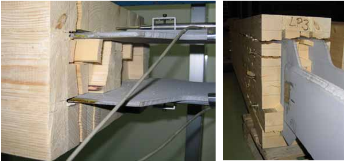
Kuva 5.10. Osittaisia lohkeamismurtoja LP3-koekappaleen keskilamellissa ja toisessa reunalamellissa.
