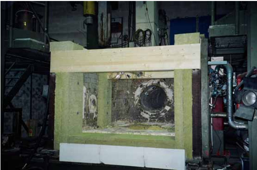
Kuva A.34. Palkkikenkäliitos uuniin asennettuna ennen koetta. Kuva uunin edestä.
