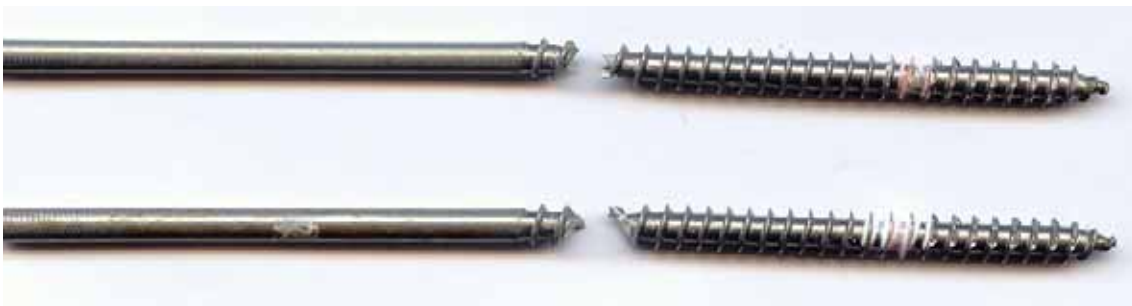
Kuva 6.4. Vetokokeissa murtoon testattuja Assy 6x140 A2 -ruuveja.
