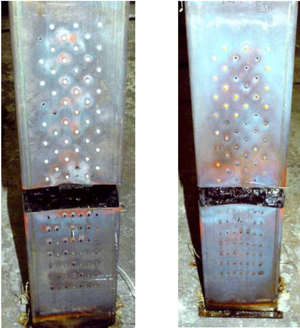
Kuva 6.16. Holkkiliitokset palonkestävyysskoheen jälkeen.
