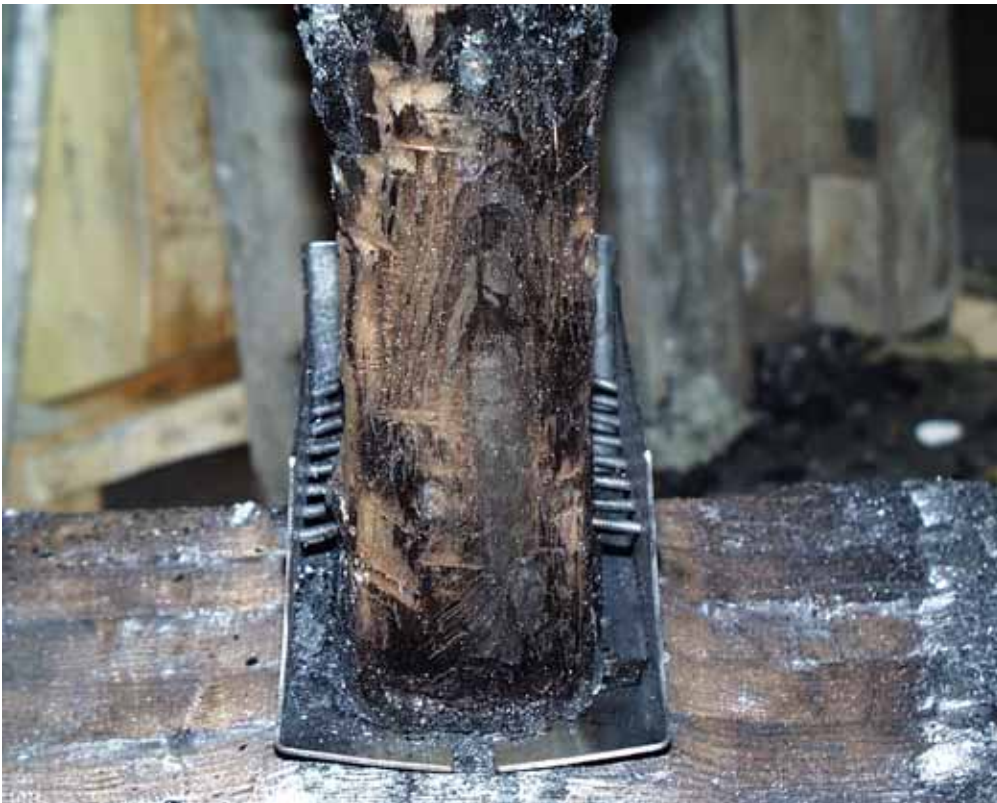
Kuva A.56. Palkkikenkäliitos (reunapalkki) kokeen jälkeen, kun hiiltymä poistettu.
