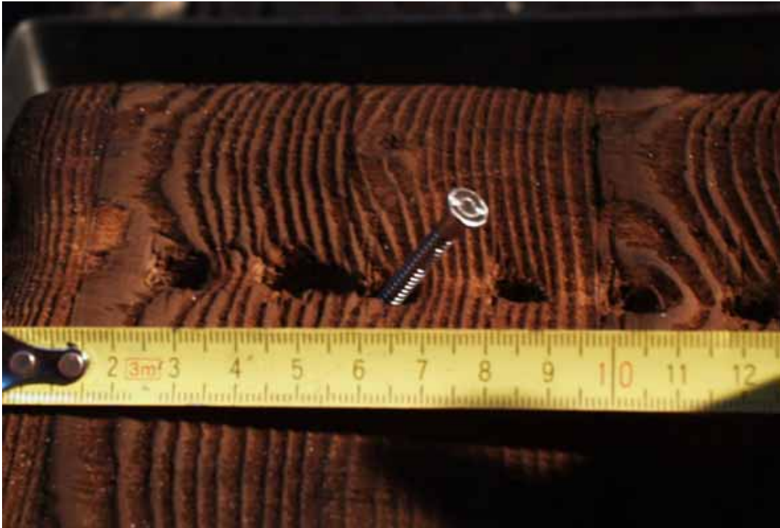
Kuva A.59. Poikkipalkin naulojen kohta kokeen jälkeen, kun hiiltymä poistettu.
