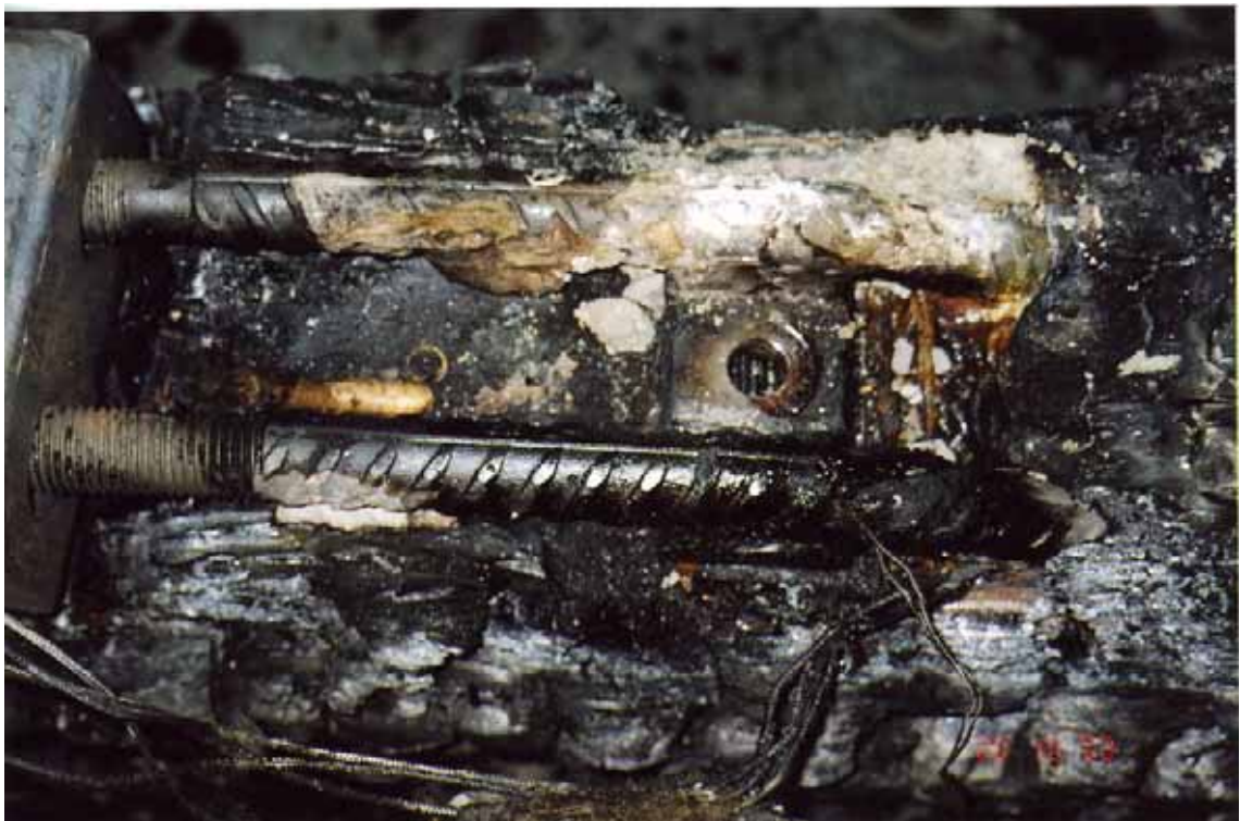
Kuva B.35. Liitoksen ruuvi leikkautunut poikki (yksi lisähitsi) ja ns. pyykkilautateräslevyt liukuneet.
