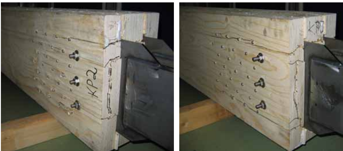
Kuva 5.12. Palamurto KP2 ja KP3 -koekappaleiden reunalamellissa.
