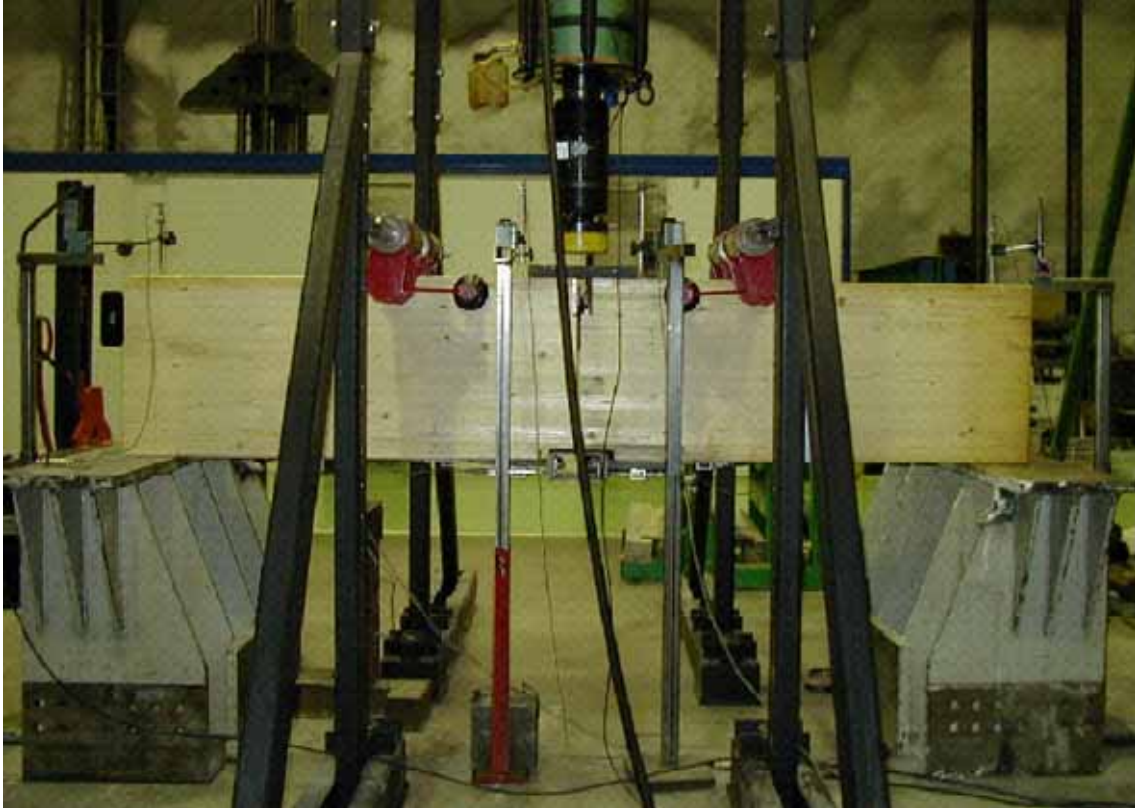
Kuva 4.3. Kuormitus ja mittausjärjestelyt.
