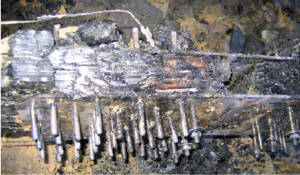
Kuva 5.26. Kertopuun tappivaarnaliitos palon jälkeen (25.4.2005).
