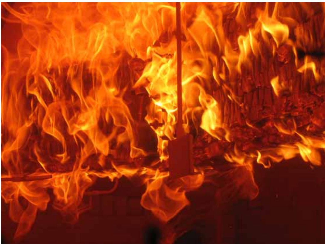
Kuva C.31. Liitos ei kannata kuormaa. Aika 57 minuuttia.
