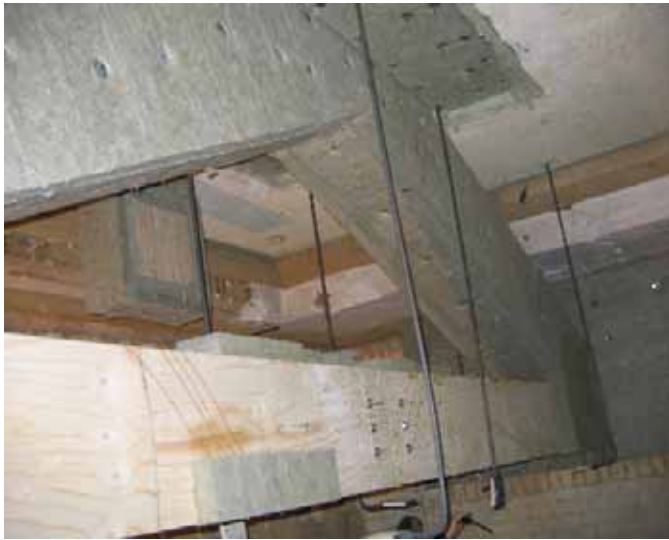
Kuva 5.20. R60-liitoskokeen koejärjestely, kuvia uunista. Koe 25.4.2005.
