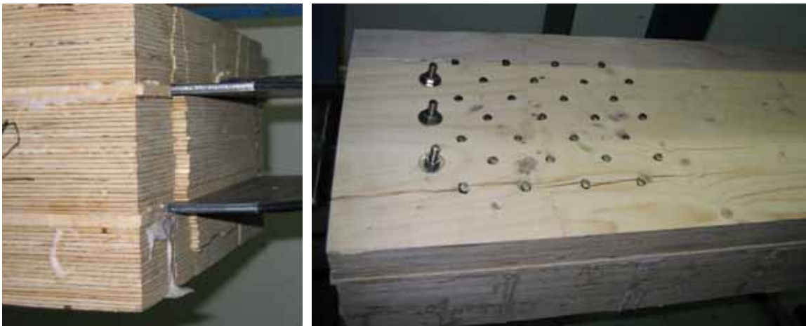
Kuva 5.11. Lohkeamismurto keskilamellissa KP-sarjan koekappaleissa.
