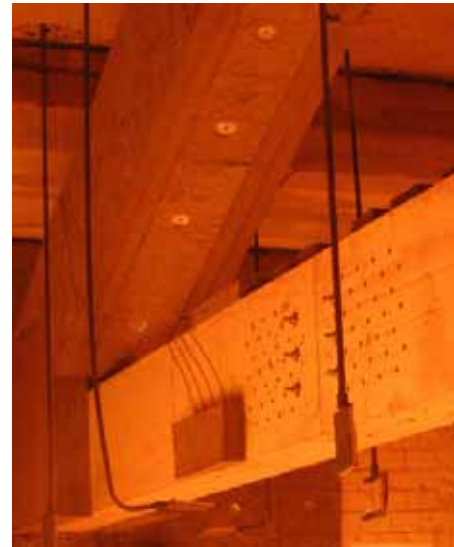
Kuva 5.20. R60-liitoskokeen koejärjestely, kuvia uunista. Koe 25.4.2005.
