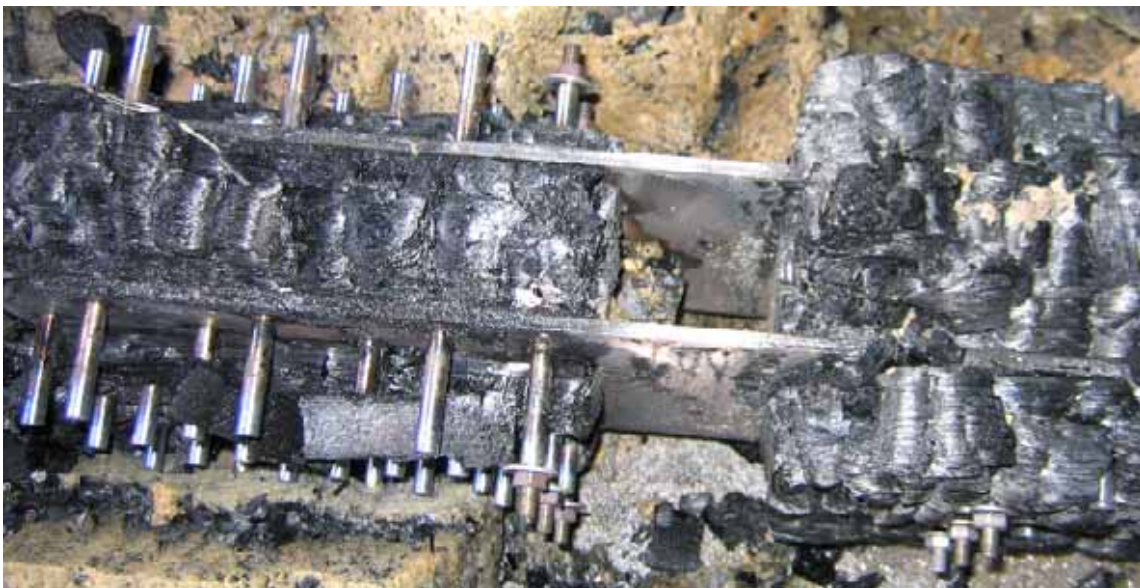
Kuva 5.25. Liimapuun tappivaarnaliitos palon jälkeen (20.4.2005).
