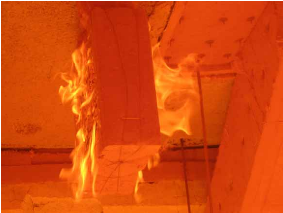
Kuva C.26. Koekappale 62 min palon jälkeen.
