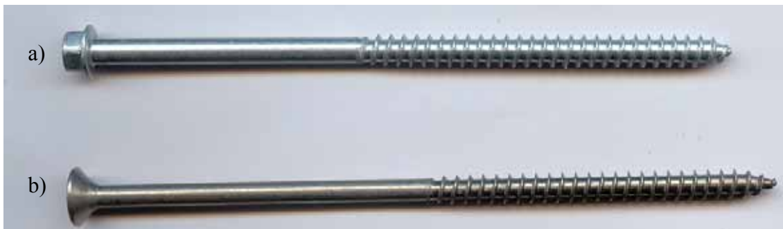
Kuva 6.3. Koekappaleissa käytetyt ruuvit: a) SFS-TDA-S-6,5x127 ja b) Assy A2 6x140.
