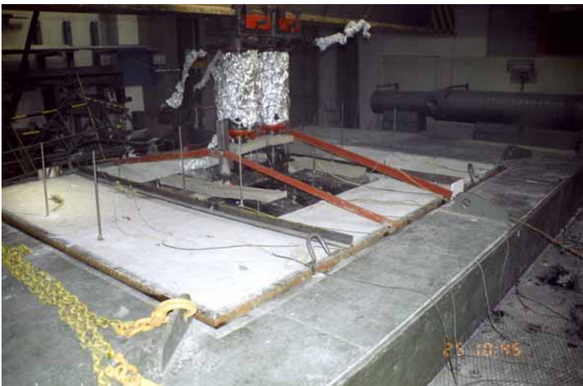
Kuva C.38. Uuni ja kuormitusjärjestely uunin päältä.
