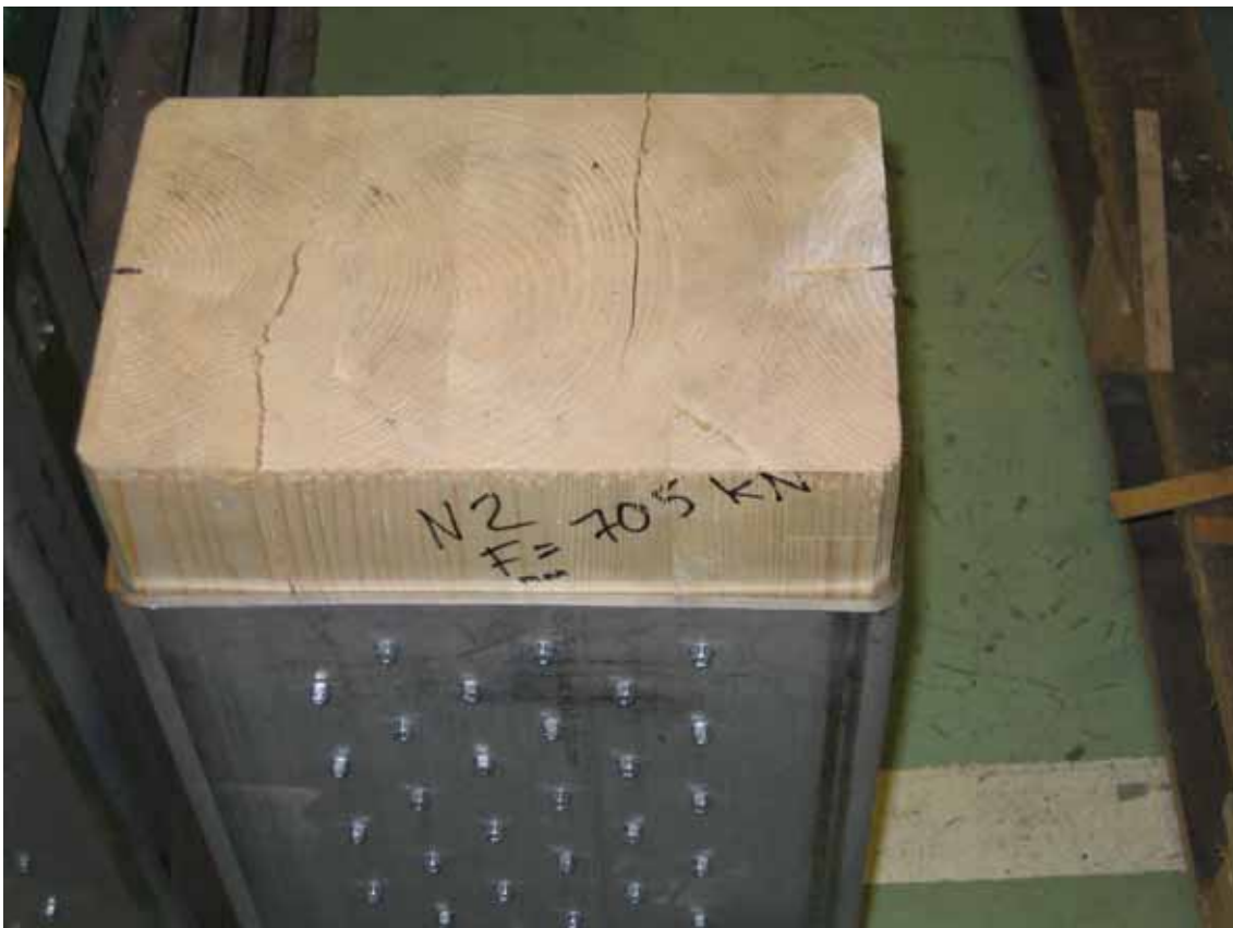
Kuva 6.6. Koekappale nro N2 murtokuormituksen jälkeen.
