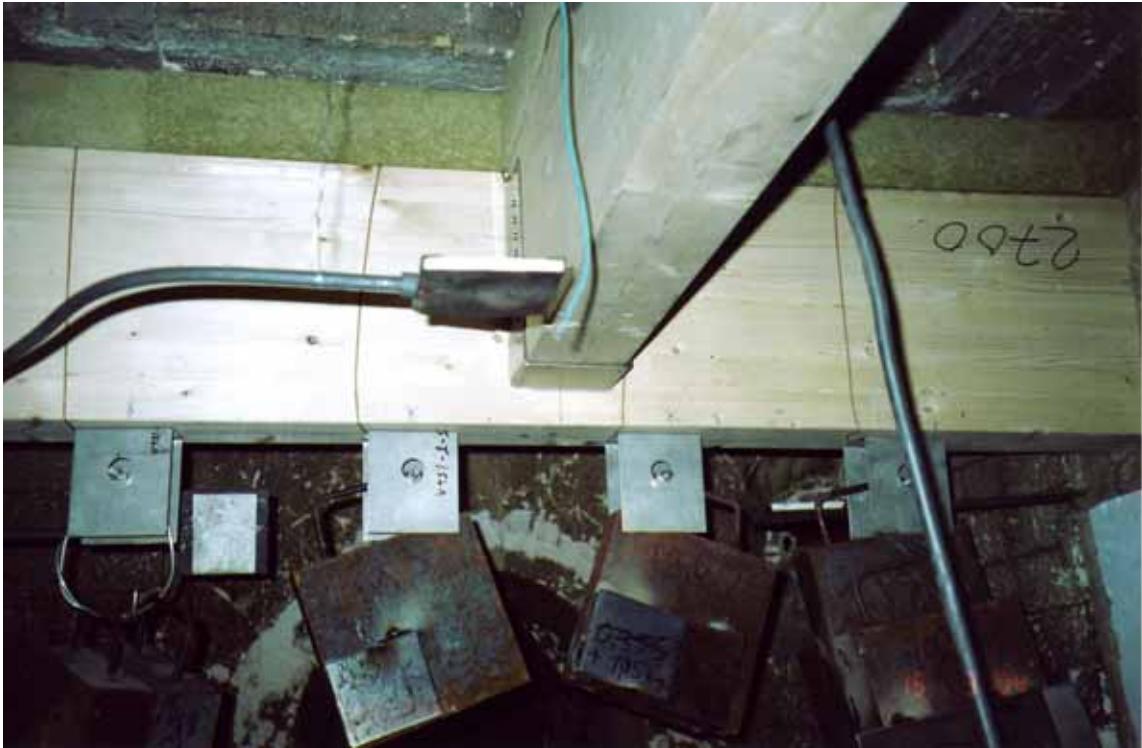
Kuva A.49. Palkkikenkäliitos uunin sisältä katsottuna.
