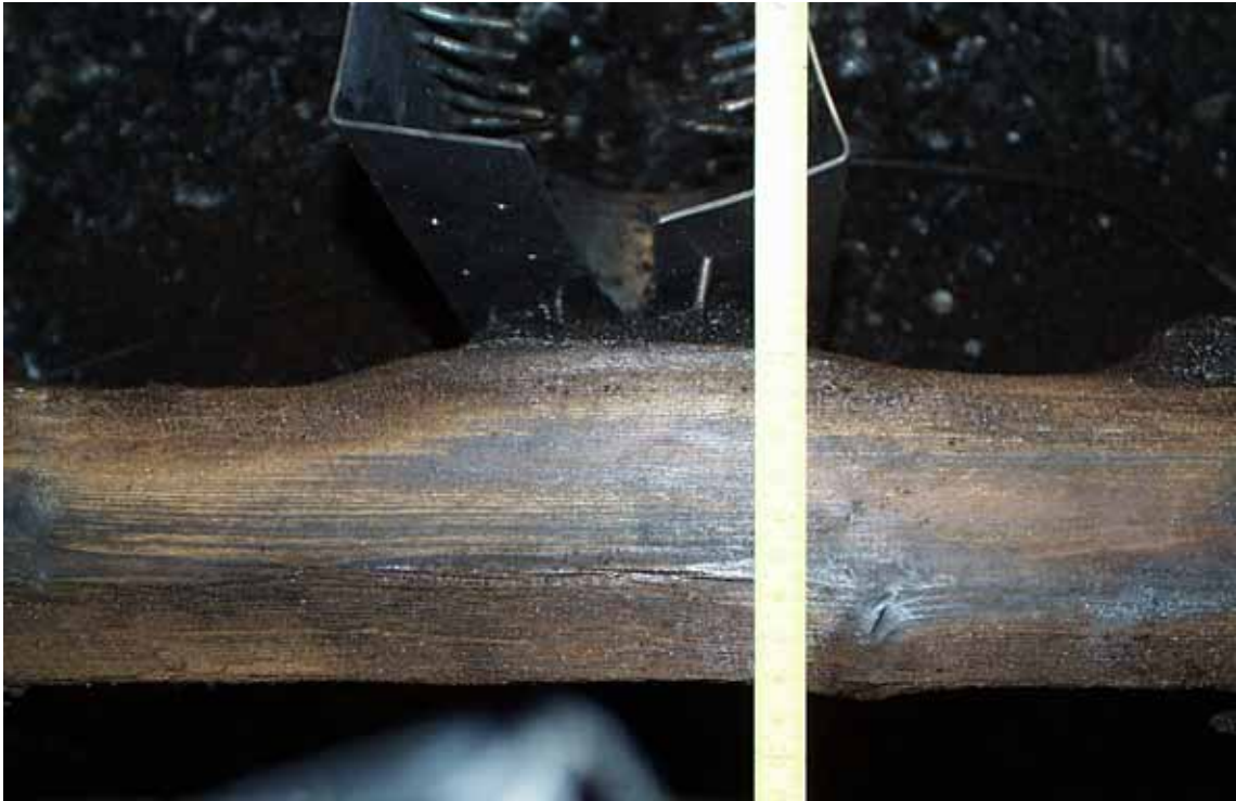
Kuva A.57. Palkkikenkäliitos kokeen jälkeen, kun hiiltymä poistettu.
