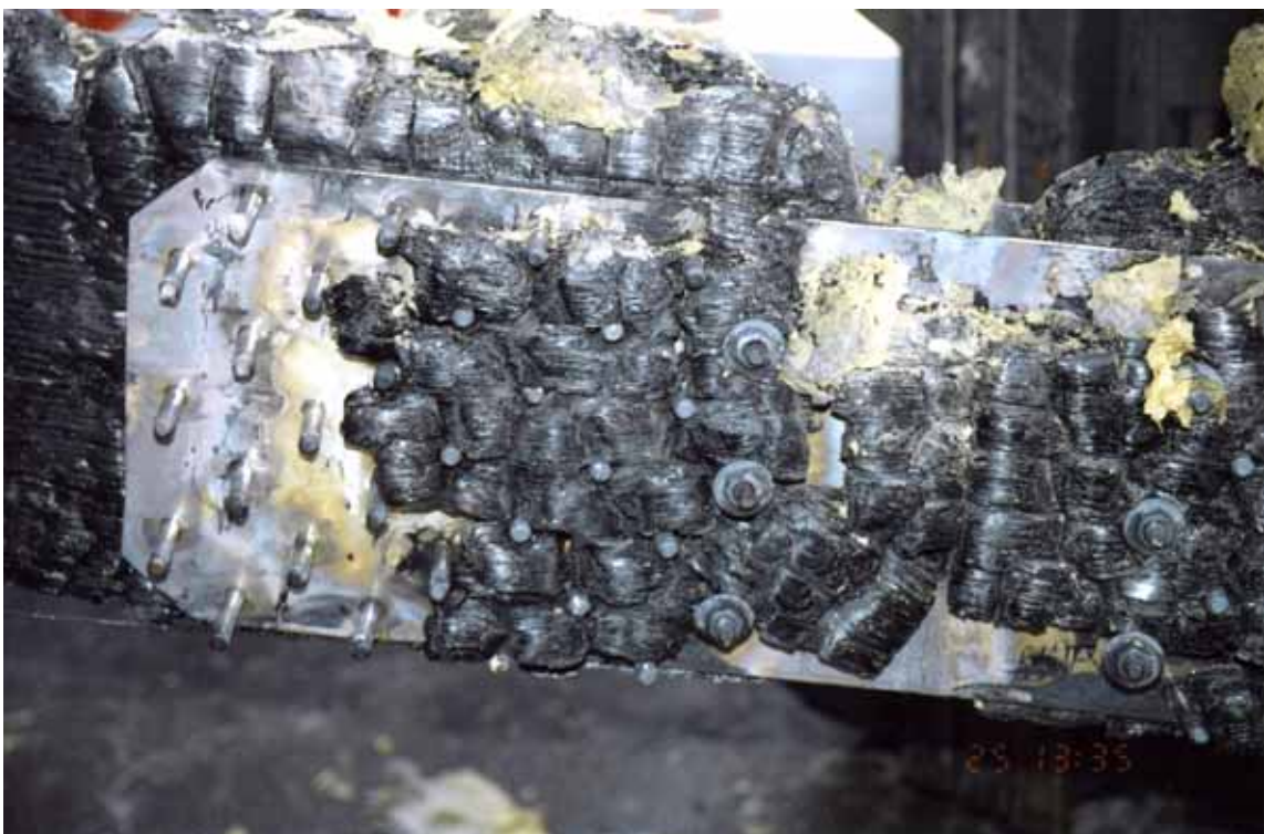
Kuva C.44. Koekappale palon jälkeen.
