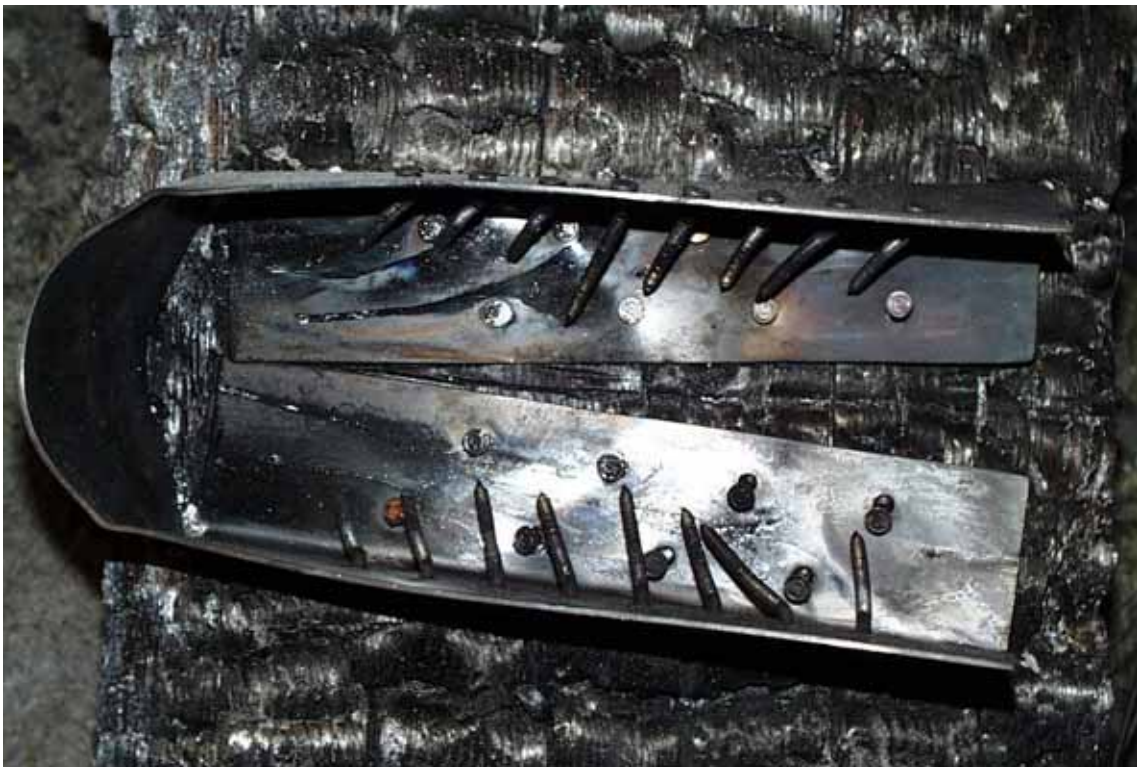
Kuva A.54. Palkkikenkä kokeen jälkeen.
