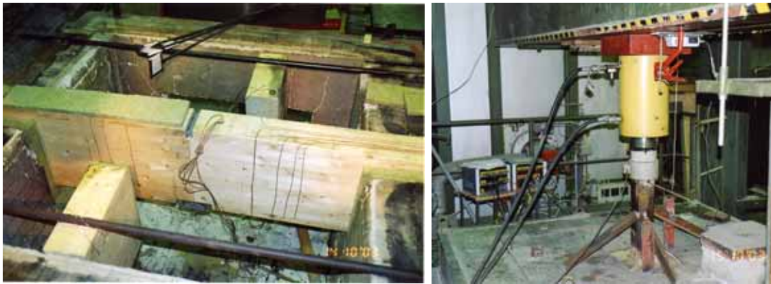
Kuva 4.9. Palonkestävyyskokeen koejärjestely: palkki uunissa (vas.) ja kuormitus-sylinteri (oik.).
