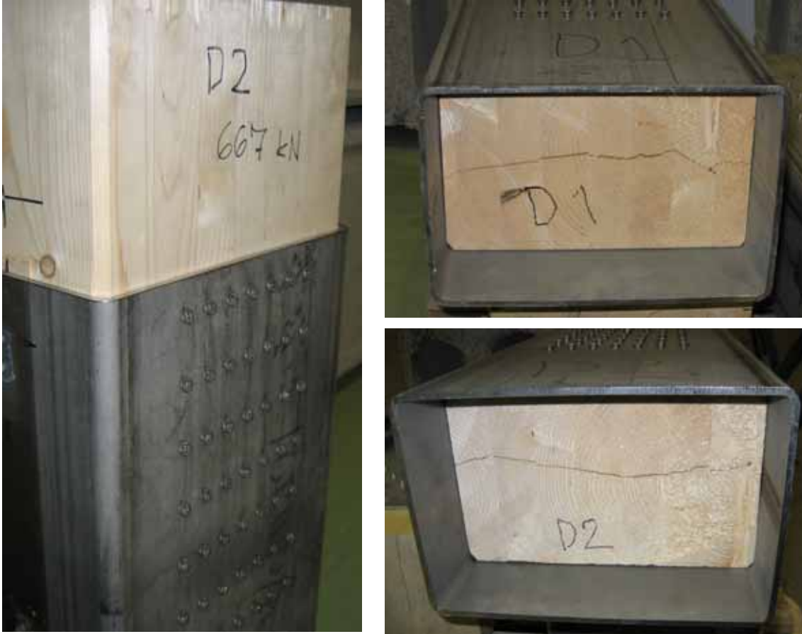
Kuva 6.7. Valokuvia murtoon kuormitetuista vinoruuviliitoksista.
