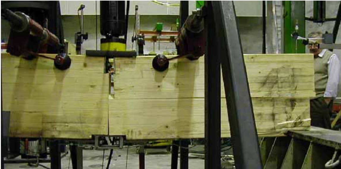
Kuva 4.5. Tukipaine- ja leikkausmurtoon kuormitettu koekappale.
