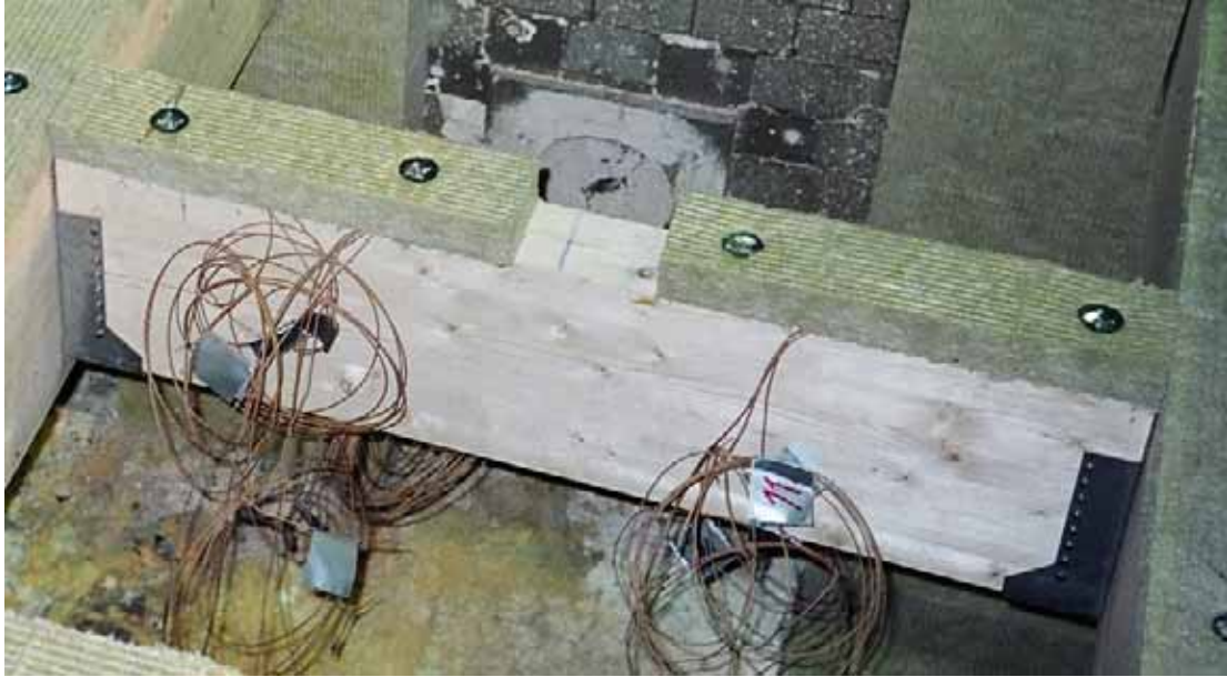
Kuva 3.2. Palkkikenkäliitos (koe 1) uuniin asennettuna ennen koetta.
