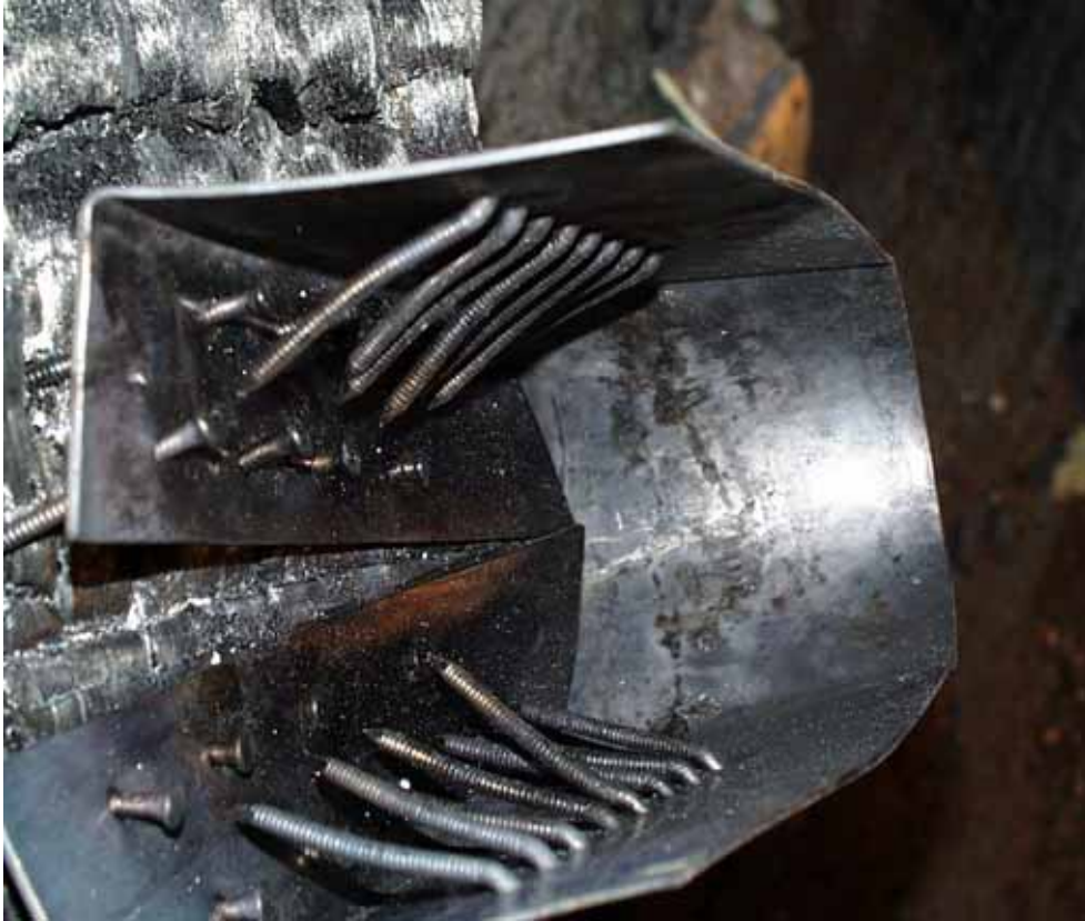
Kuva A.55. Palkkikenkäliitos kokeen jälkeen.
