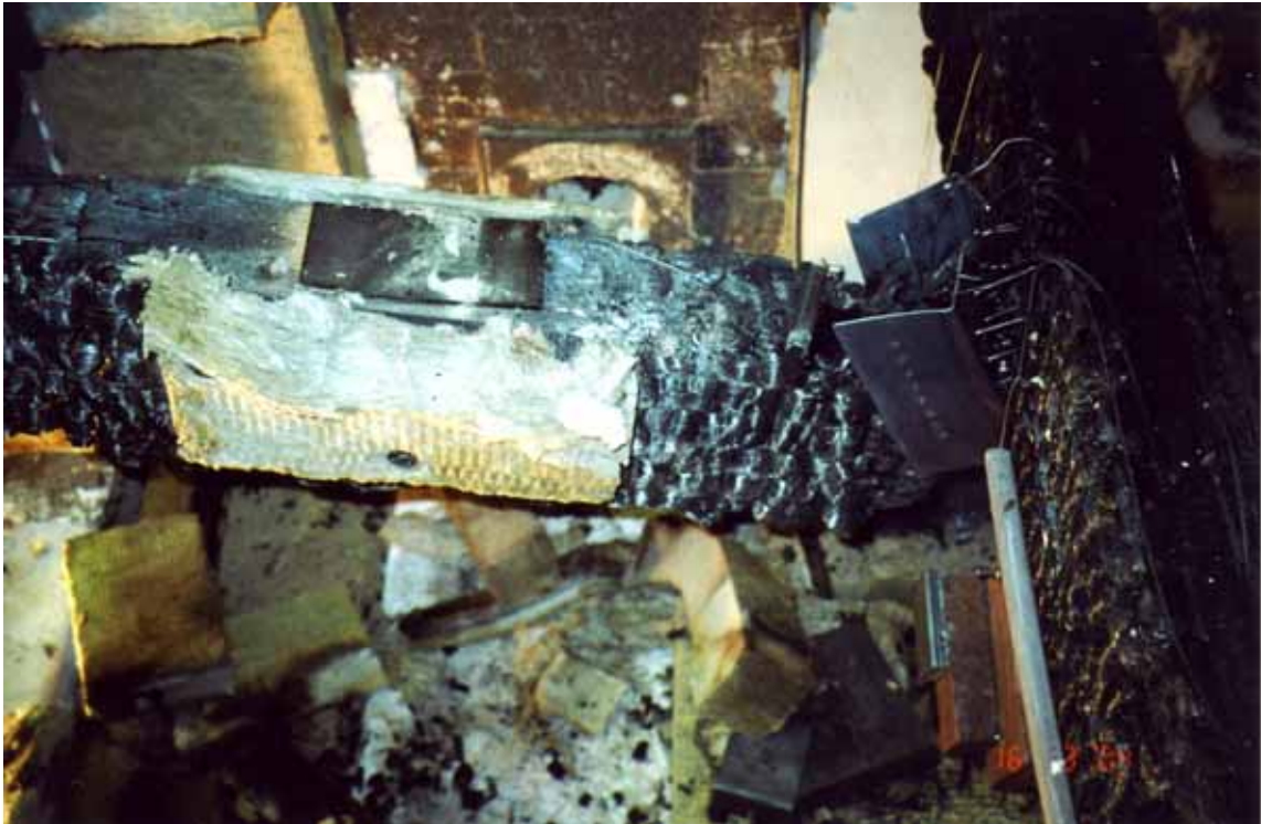
Kuva A.53. Poikkipalkin pääpalkin palkkikenkäliitos kokeen jälkeen.
