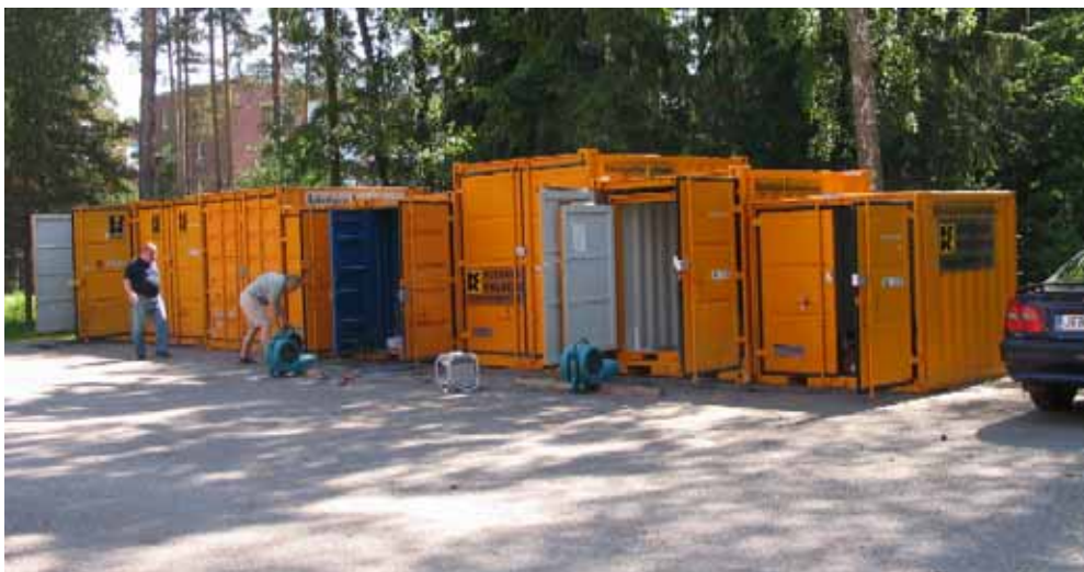
Kuva 9. Kontit ja kaksi puhdistajaa VTT:n tilojen takapihalla. Koekappaleiden puhdistus ja hajunpoisto suoritettiin kuvan konteissa.
