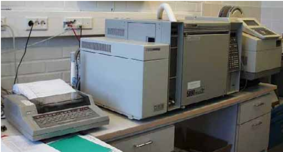
Kuva 14. VOC-näytteiden analysointi GC/MSD-laitteistolla.
