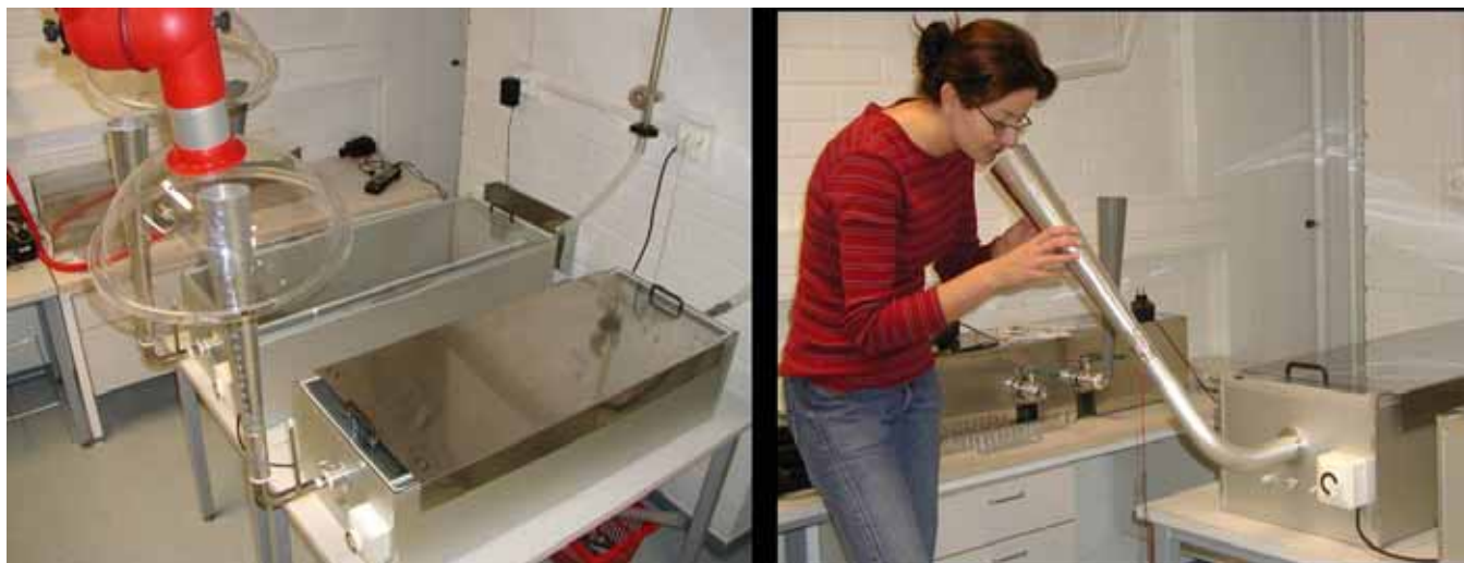
Kuva 10. Näytteen aistinvarainen arviointi alumiinikammioista. Suppilosta haistellaan kammioilmaa ja sitä arvioidaan kuvan 11 mukaisen kaavakkeen tehtävänannon mukaan.
