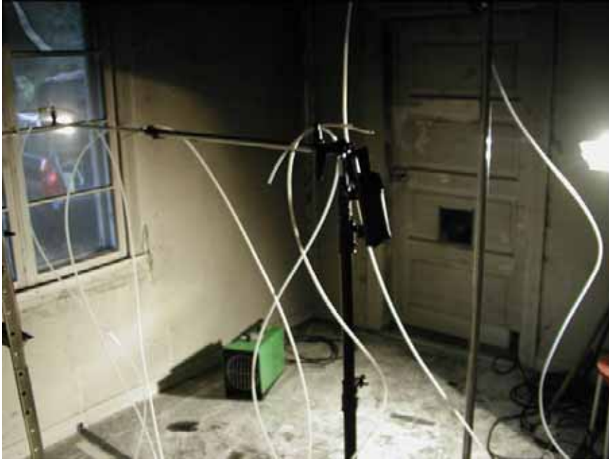
Kuva 73. Lohjan polttokohde: sisäilmamittaus heti polton jälkeen. Huom. pintojen nokeentuminen näkyy selvästi kuvassa.
