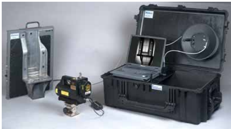
Kuva 29. Kuvassa pienikokoinen flat-panel -laitteisto. [29]
