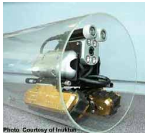
Kuvat 24 ja 25. Kummassakin kuvassa traktorivetoinen putkistokamera. [1], [35]
