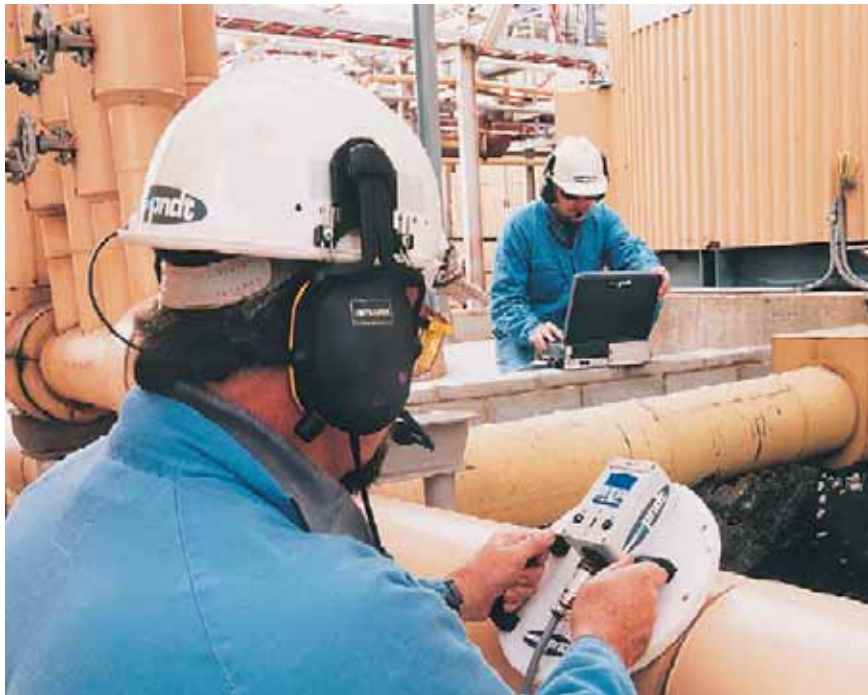
Kuva 16. Kuvassa Incotest-laite toiminnassa. [12]
