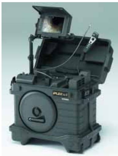
Kuvat 20 ja 21. Kuvassa nykyaikainen endoskooppilaitteisto ja endoskooppikuva putken sisältä. [33]
