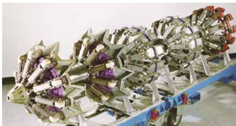
Kuva 15. Kuvan porsas on tarkoitettu erilaisille halkaisijoille ja putkille, joissa on venttiileitä. Halkaisija-alue kuvan porsalle on 16–30 tuumaa. [32]
