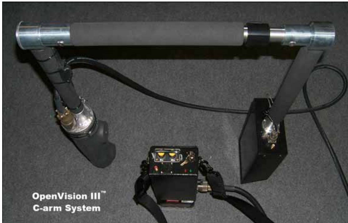
Kuva 10. Kuvassa on C-kaarikuvauslaite. Laitteeseen kuuluvat myös turvalaseihin liitettävä näyttö ja videotallennuslaitteisto pienellä lcd-monitorilla. [24]
