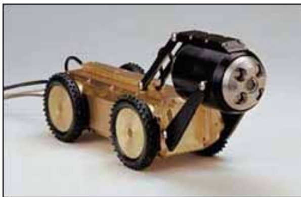
Kuvat 24 ja 25. Kummassakin kuvassa traktorivetoinen putkistokamera. [1], [35]
