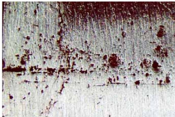
Kuva 6. Yläkuvassa ruostumattoman teräksen hitsissä olevia paikallisia pistesyöpymiä (lähde: VTT). Alakuvissa laajempialaista pistekorroosiota (lähde: http://www.outokumpu.com ).
