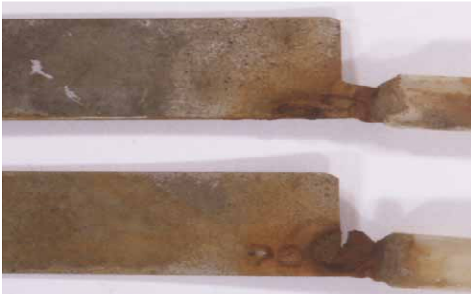
Kuva 7. Itämeressä Helsingin edustalla 15 m:n syvyydessä 7 kuukautta olleet materiaalista EN 1.4301 valmistetut näytekappaleet altistuksen jälkeen. Näytteen ja näytteenpiittimen liitoskohdassa on todettavissa voimakasta rakokorroosiota ja näytteessä silminnähtäviä pistesyöpyymiä (lähde: VTT).
