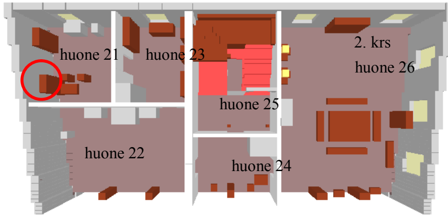
Kuva 34. Palavalla nesteellä sytytettävä tuhopoltto puuesineistöä sisältävässä huoneessa 2. kerroksessa, syttymiskohta ympyröity.
