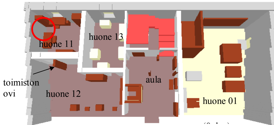
Kuva 32. Toimistohuoneen palo 1. kerroksessa, syttymiskohta ympyröity.
