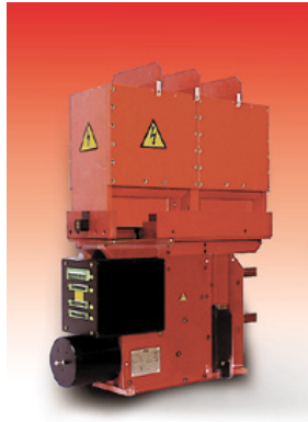
Kuva 4-8. GE:n GERapid-sarjan DC-katkaisija. Kuvassa ylhäällä punaiset kipinäsammutuskammiot, alhaalla musta pyöreä solenoidivetokoneisto ja sen päällä ohjainpiirin liitännät. [40]
