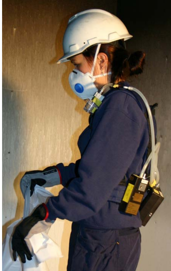
Kuva 41. Hengitystiealtistumisen mittauslaitteisto. Kuvassa näkyy myös kokeessa 1 käytettyä suojavarustusta.
