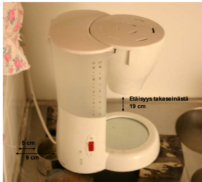
Kuva 19. Sytytykseen käytetty kahvinkeitin.
