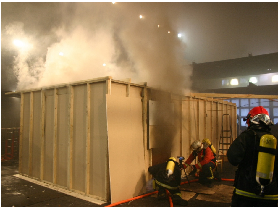
Kuva 22. N. 16 min kuluttua sytytyksestä oviaukon korkeutta pienennettiin n. 50 cm.
