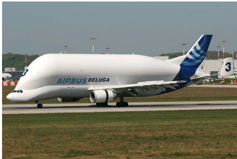
Kuva 5. Airbus käyttää omia A300 malliin perustuvia Beluga-kuljetuskoneita osien kuljettamiseen maasta toiseen (kuva Jukka Hemilä).
