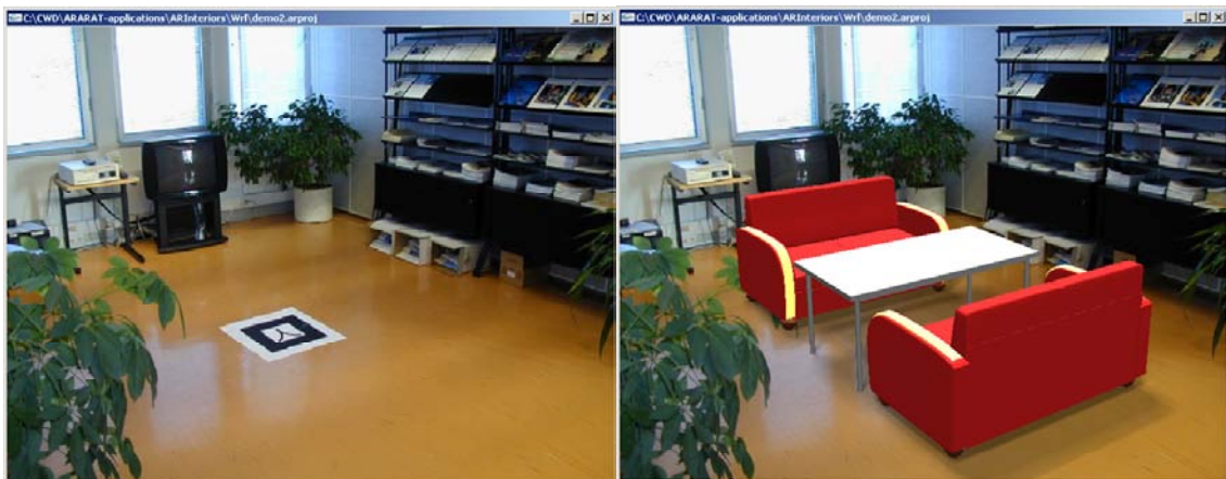
Kuva 1. Lisätty todellisuus muuttaa käyttäjän näkemää todellisuutta. Vasemmanpuoleisessa kuvassa lattialle on asetettu kohdistuspiste, ns. markkeri, jonka suhteen virtuaaliobjektit asennetaan. Oikeanpuoleinen kuva on se, mitä katselija näyttölaitteella näkee.
