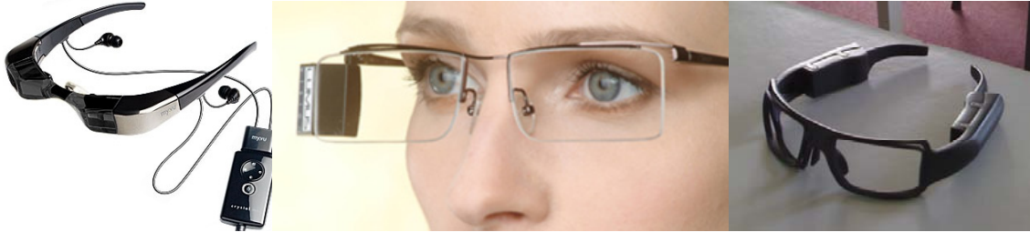
Kuva 5. Tulevaisuuden vaihtoehtoja: MyVu Crystal -videolasit (vasemmalla); Lumus optical see through -lasit (keskellä) ja Laserin prototyyppi (oikealla).
