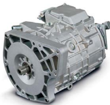
Kuva 8-11. Mitsubishi iMIEV Permanent Magnet Motor 47 kW / 180 Nm.
